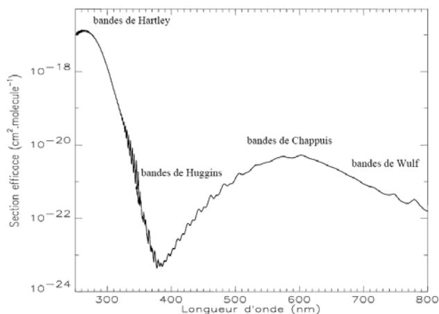
Figure 5 : Sections efficaces d’absorption de l’ozone dans l’UV-visible.
